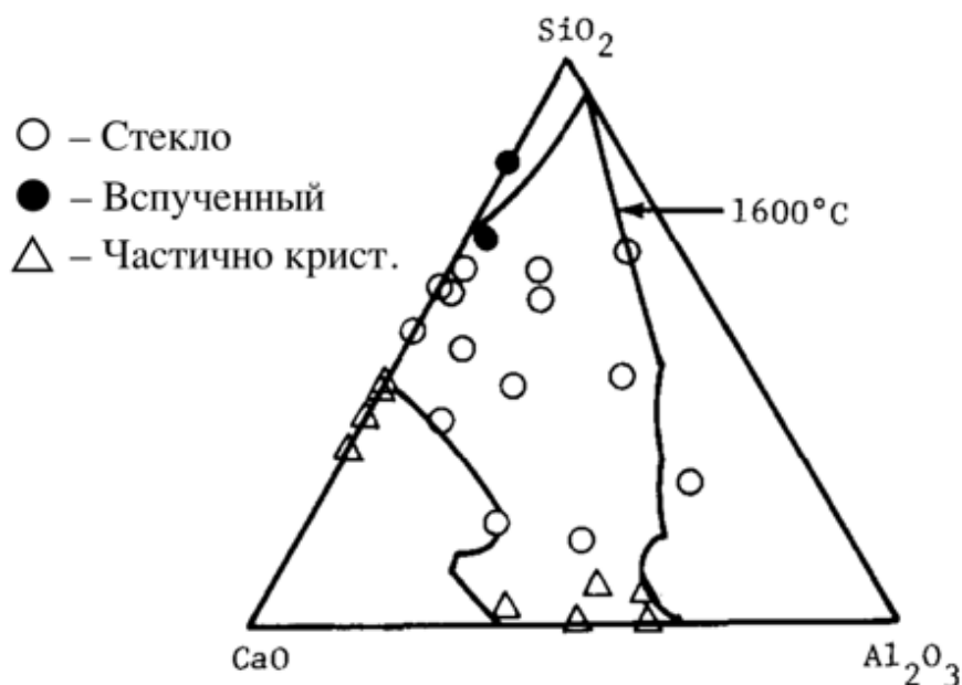
Рисунок 10 – Область стеклообразования в системе CaO–SiO 2 –Al 2 O 3 при 1600 °C. Указанная композиция содержит 10 масс. % Si 3 N 4 .
